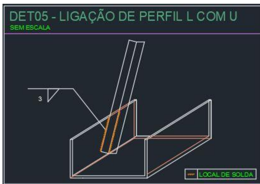
Figura 8 - Exemplo de ligação soldada utilizada no projeto.
